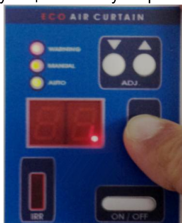
Рисунок 8. Показания индикаторов при удержании кнопки MODE
