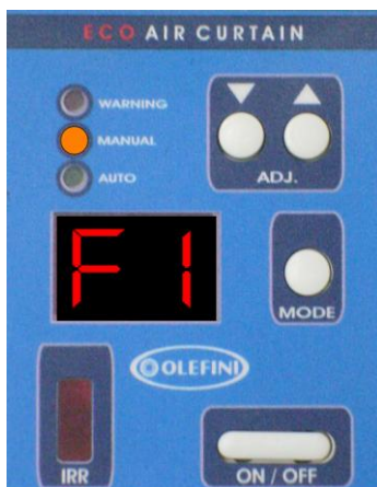
Рисунок 4. Оранжевый индикатор указывает на режим ручного управления (MANUAL).
