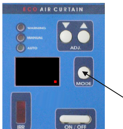
Рисунок 7. Удерживать кнопку MODE 10 секунд
