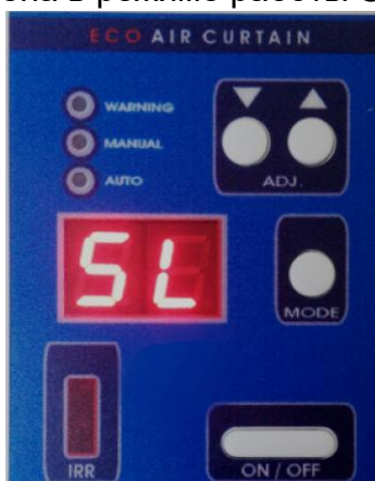
Рисунок 9. Показания на цифровой панели при режиме работы SLAVE (ВЕДОМЫЙ)
