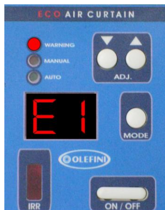
Рисунок 11. Указание о проблеме с перегревом (E1)
