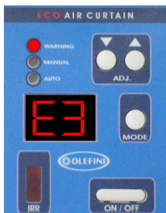
Рисунок 13. Указание о проблеме с внешним температурным датчиком (E3)
