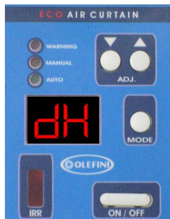
Рисунок 10. Показания на цифровой панели при режиме самоохлаждения (dH)
