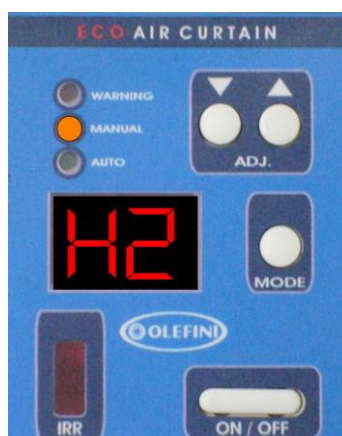
Рисунок 6. Выбрана средняя ступень мощности нагрева (66%)
