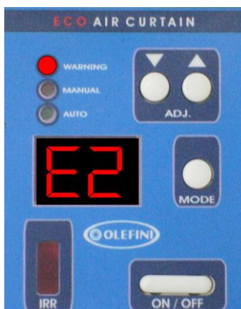
Рисунок 12. Указание о проблеме с вентилятором (E2)
