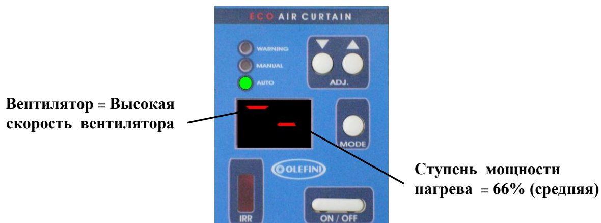
Рисунок 3. Красная черта слева указывает на высокую скорость вращения вентилятора, красная черта справа указывает на среднюю степень мощности нагрева (66%).
